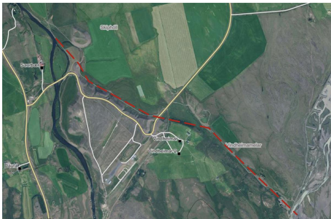
Mynd 11.2 Tillaga að legu jarðstrengs (rauð brotalína) á Héraðsvatnaleið, um 3 km að lengd. Loftmynd frá map.is.
